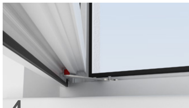
2 Wkładamy podstawę blokady do ramy okna w odległości ok 60 mm od wewnętrznej krawędzi ramy okna.
